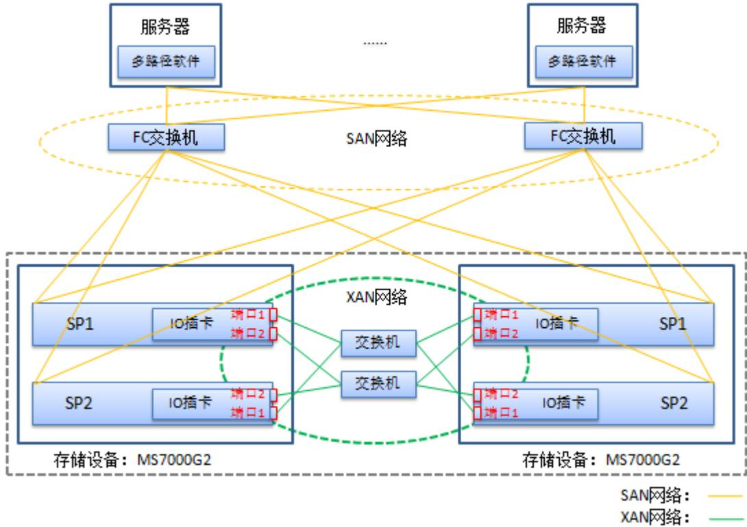
图4-2 双控 XAN 典型组网图（交换机连接）
