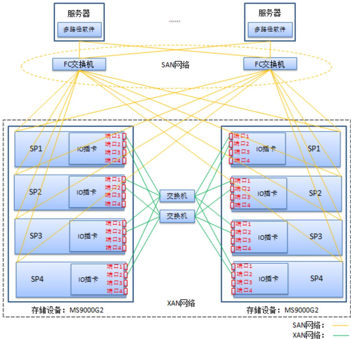
图4-4 四控 XAN 典型组网图（交换机连接）
