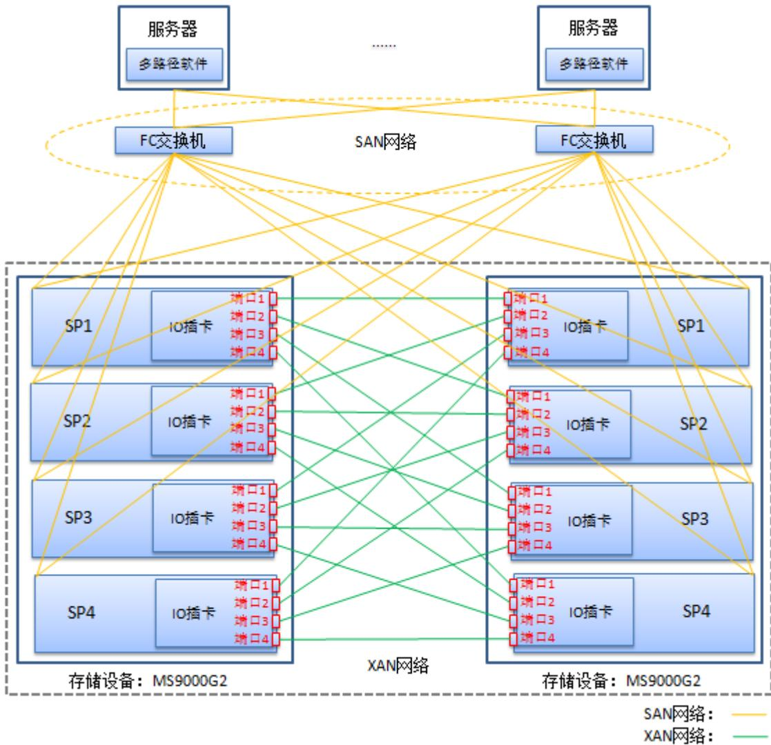
图4-3 四控 XAN 典型组网图（MESH 直连）
