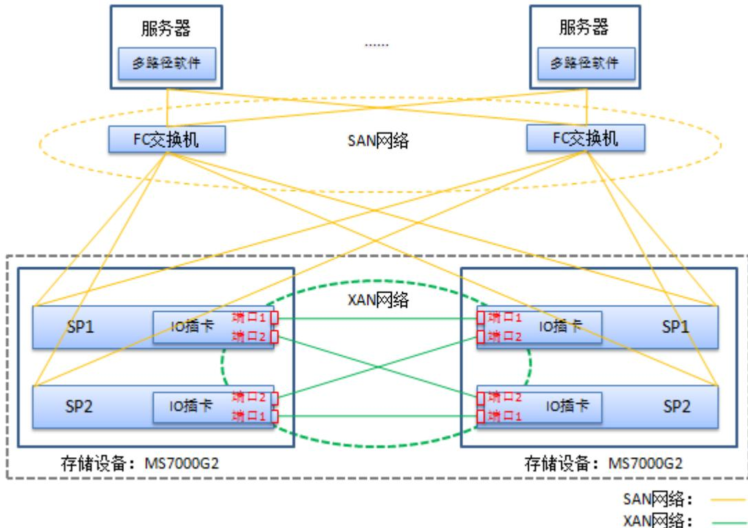
图4-1 双控 XAN 典型组网图（MESH 直连）
