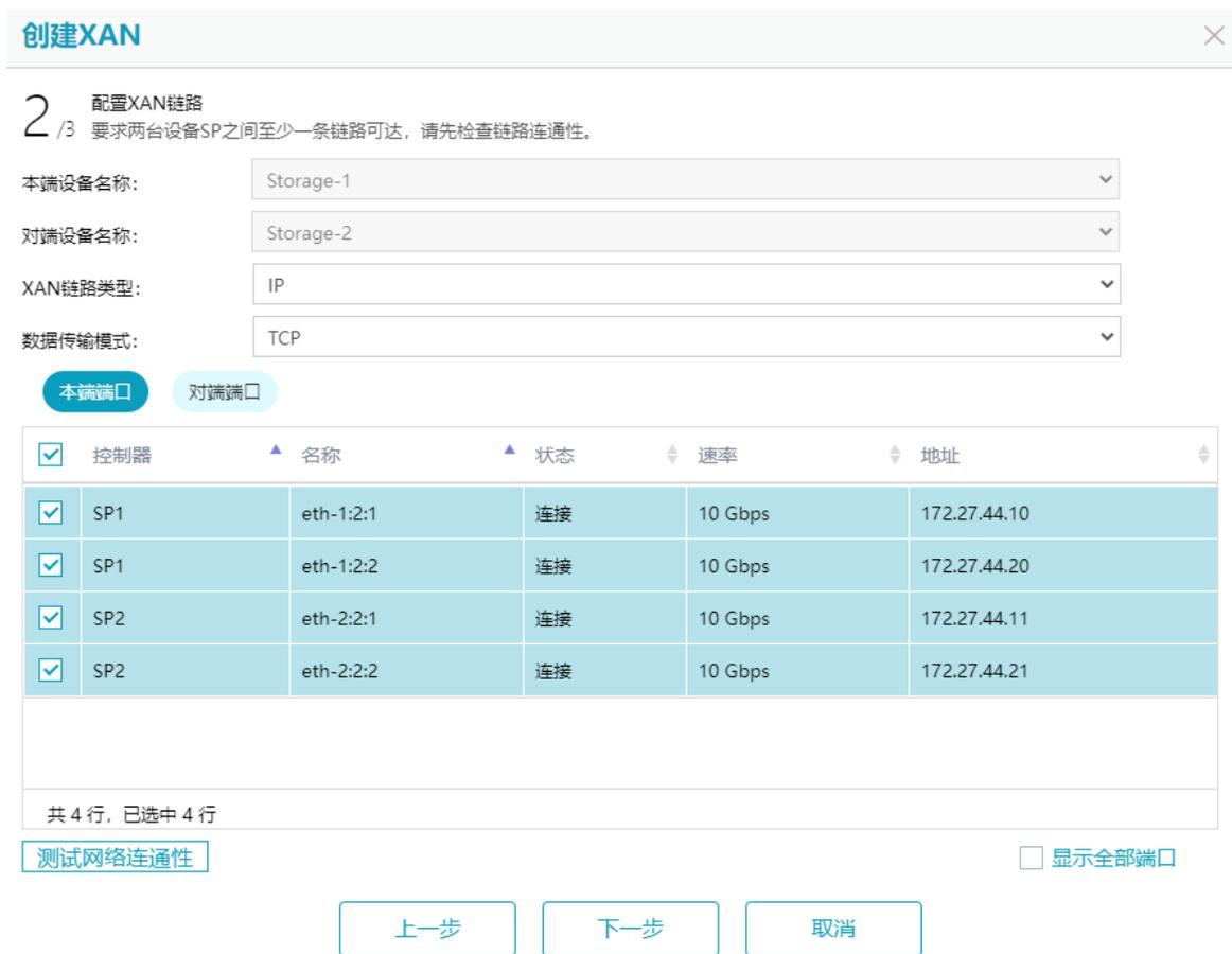
图6-3 创建 XAN（IP 管理链路+IP 数据链路）向导界面（二）
