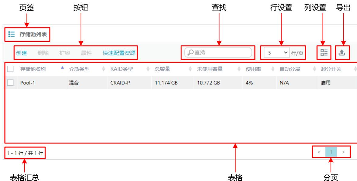
图3-9 ODSP Scope+信息显示区示例
